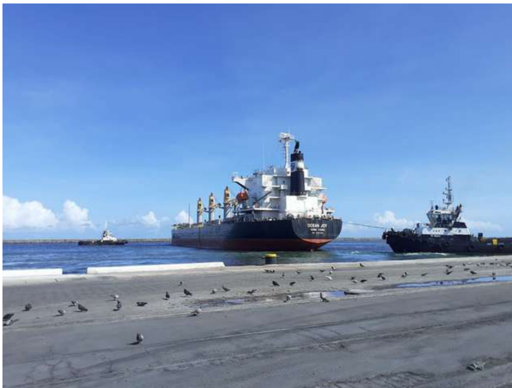
Rebocadores atuando no giro do navio na bacia de evolução, após desatracação.
